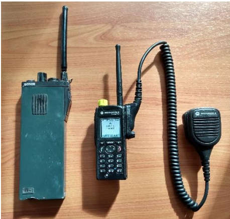
Links analoges Funkgerät, rechts neues Digitalfunkgerät
